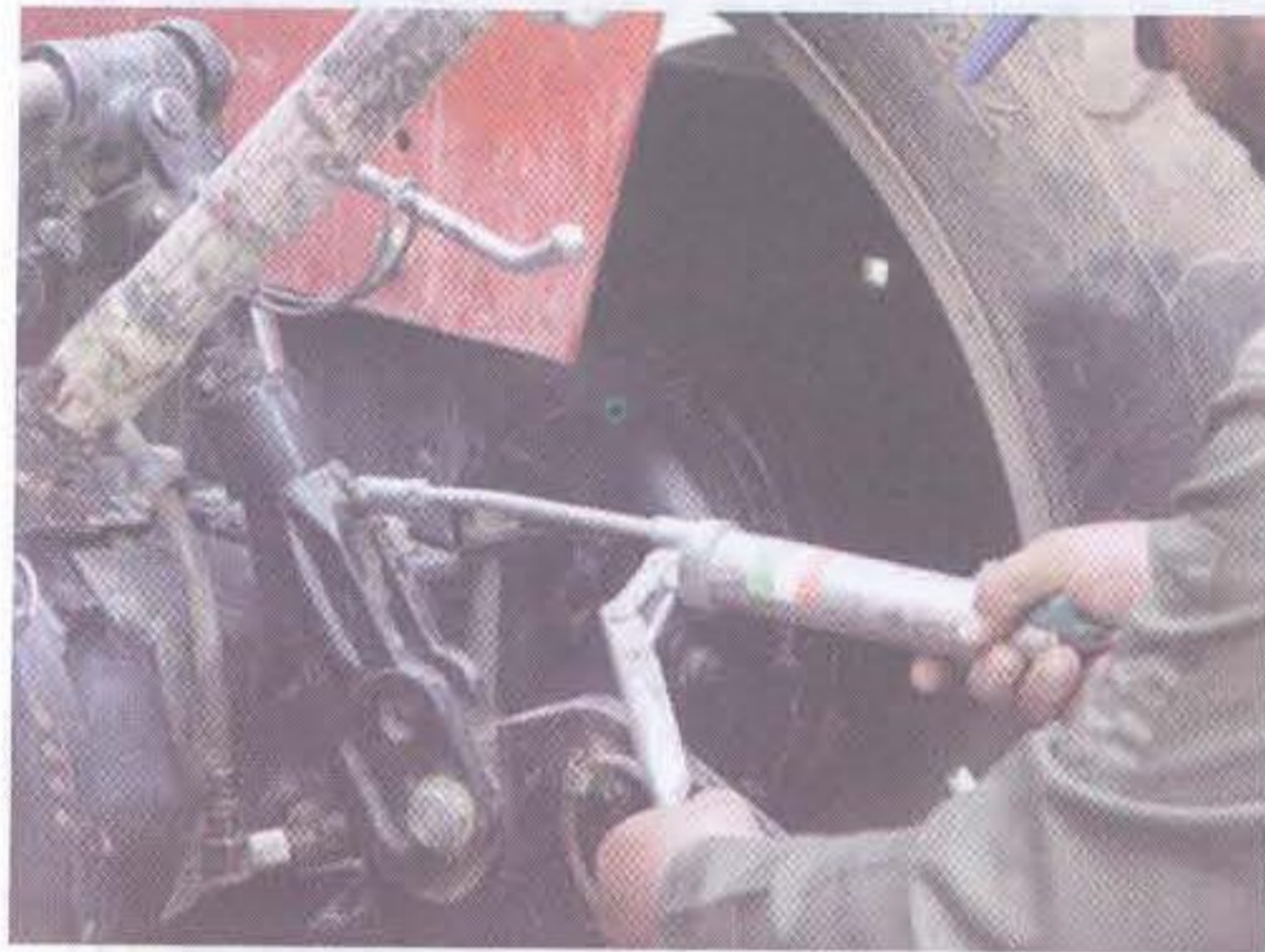
۱(ب): گریس کاری قسمتهای تراکتور
