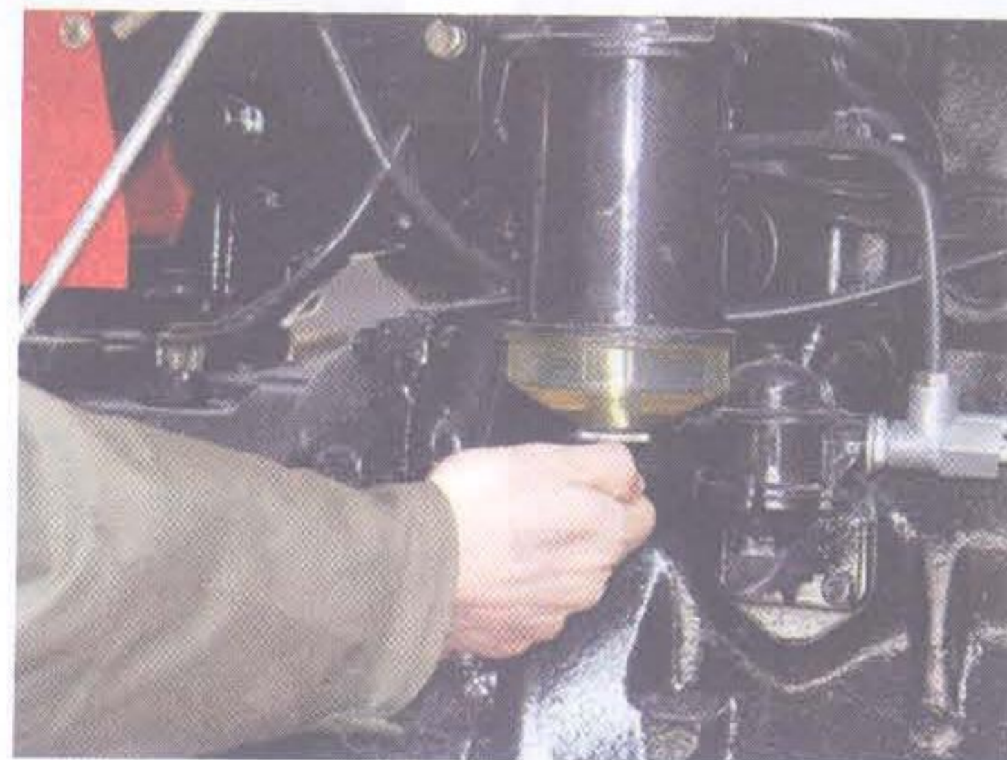
۵- تخلیه صافی سوخت از رسوبات جمع آوری شده
