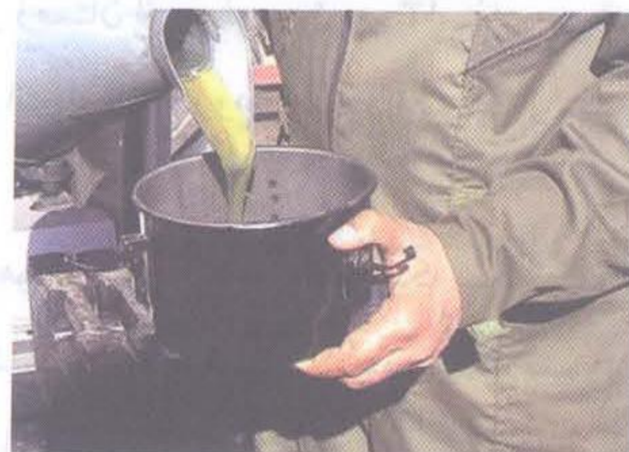
۲(الف): تعویض روغن صافی سوخت
